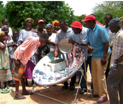
Mit einem Solarofen kann man ohne Strom und Feuer kochen.
